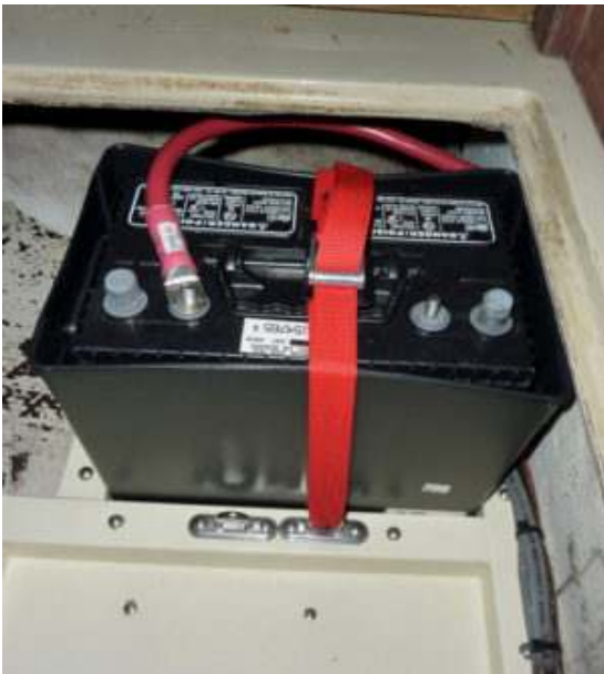
Doğru yerleştirilmiş aküde asit
