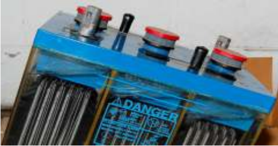
Doğru yerleştirilmiş aküde asit
