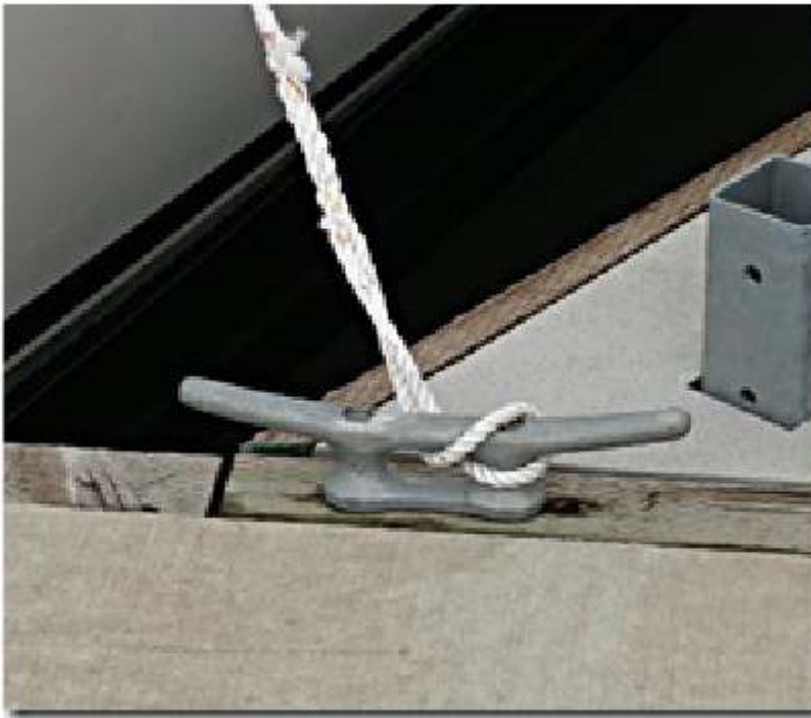
Pontonda örülmüş kasanın koç boynuzuna geçirilmesi
